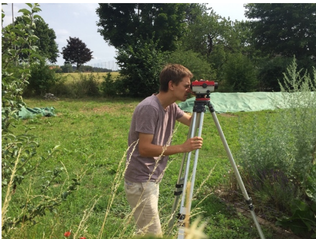
Abbildung 5: Messung vom Verlauf des Geländeniveaus mithilfe des Nivelliergerätes und der Nivellierlatte (Quelle: Links: eigenes Foto, rechts: Swiss Geo Level AG 2019)
